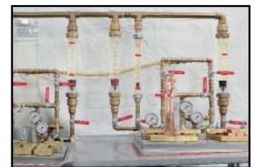
Prüfung der Dichtigkeit und des Durchflusses
