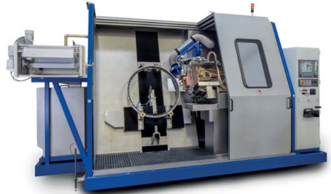
schräggestellte Härteanlage für Großringe
